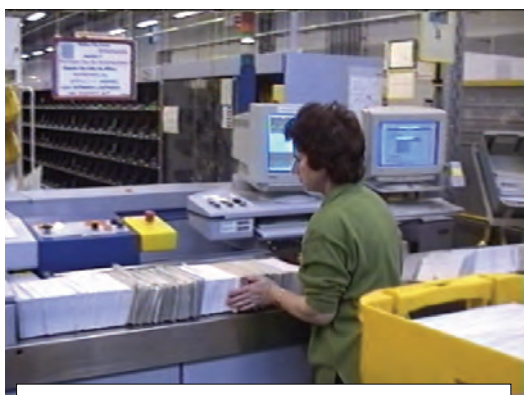
In der Briefordnerei werden die Briefe in die „Produktionsanlage“ zum Stempeln „geordnet“ eingespeist.
