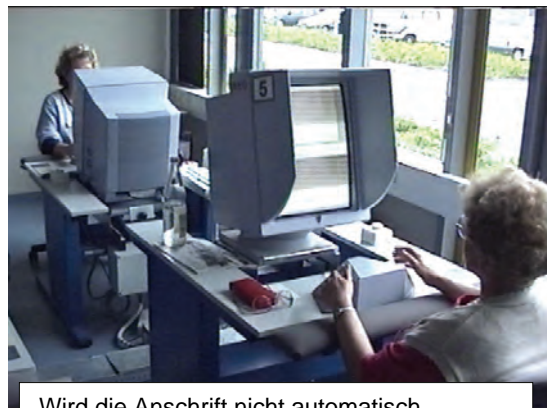
Wird die Anschrift nicht automatisch erkannt, so wird die PLZ manuell über Videoterminals eingegeben.
